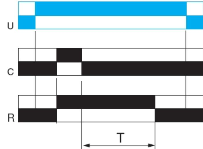
После подачи питания на реле времени и последующей подачи напряжения на управляющий вход С, выход R замыкается. В момент снятия напряжения с управляющего входа С начинается отсчет выдержки времени Т. По окончании выдержки Т выход(ы) R возвращае(ю)тся в исходное положение.
